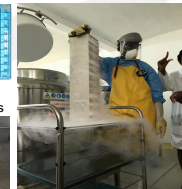
Sortie d'un rack de 12 cryoboute
